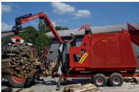
GROWI-Bündelsäge Aufbau auf Rückewagen
